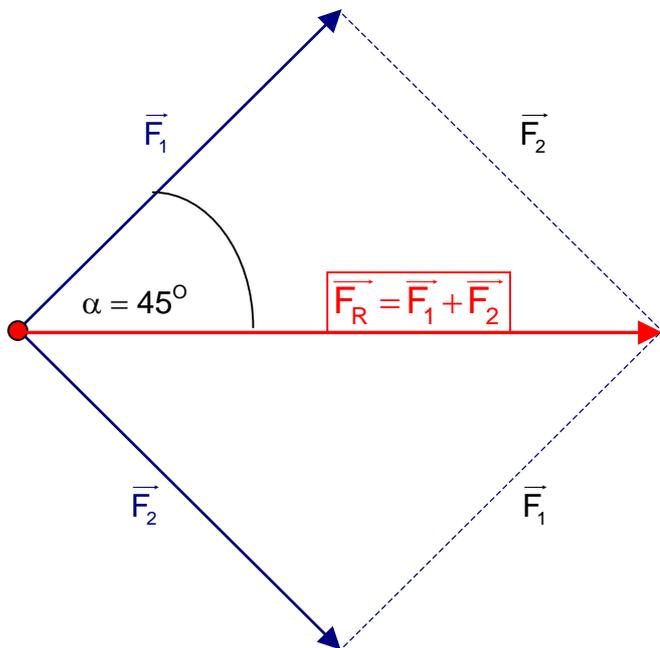
Man bildet ein Parallelogramm aus  $\vec{F}_1$  und  $\vec{F}_2$ , das in diesem Fall zu einem Quadrat wird. Die resultierende Kraft ist die Diagonale.
