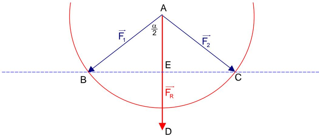
Nun zeichnet man den Kreis um A mit Radius 4 cm (40 N) . Dieser schneidet die gestrichelte horizontale Mittelsenkrechte in B und C. Damit hat man  $\vec{F}_1 = \vec{AB}$  und  $\vec{F}_2 = \vec{AC}$ .
