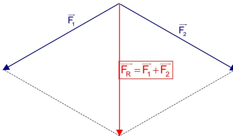
Damit entsteht ein Parallelogramm, das durch die Diagonale  $F_R$  in zwei gleichseitige Dreiecke zerlegt wird, d.h.  $F_R$  hat denselben Betrag wie  $\vec{F}_1$  und  $\vec{F}_2$ .
