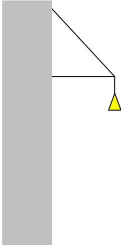
Der Typ 1 (links) benötigt eine horizontale Stange und ein Seil, das von schräg oben her den Zug abfängt und auf die Hauswand überträgt.
