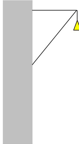
Der Typ 2 (rechts) benötigt eine schräge Stange und ein Seil, das den Zug abfängt und auf die Hauswand überträgt
